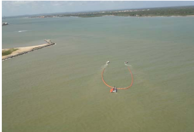
Simulação de contenção de óleo no Rio Sergipe com uso de barreiras, durante o simulado de outubro de 2012
