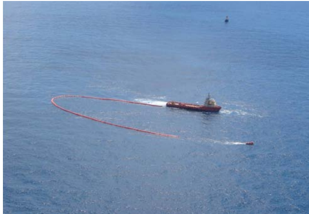
Simulação de contenção do óleo com uso de barreira lançada por embarcação recolhadora de óleo, durante o simulado realizado em março de 2012
