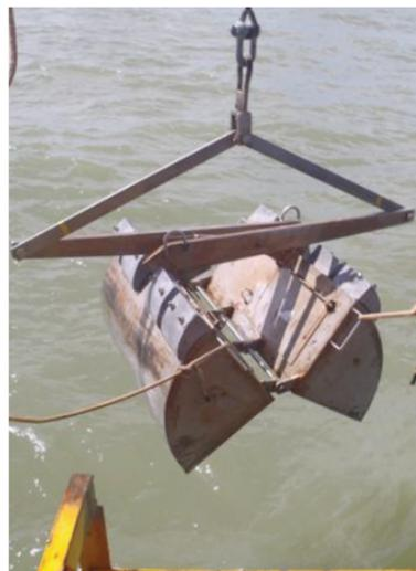
Amostrador de sedimento do tipo VanVeen
