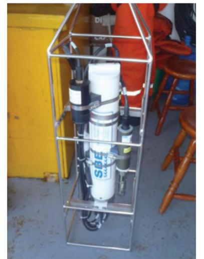
CTD utilizado para a medição da temperatura (°C) e da salinidade
