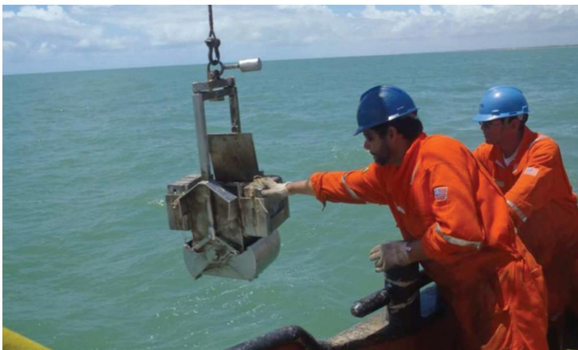
Coleta de sedimento utilizando *box corer*
